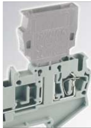
P-YJ - штекер для установки электронных компонентов, номинальный ток: 6 А, размер шага: 5,2 мм, полюсов: 1, цвет: серый
