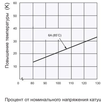
Условия испытаний: NO, AgNi, резистивная нагрузка, 250 В перем. тока, защита от флюса, комнатная температура, 1с вкл. 9с выкл.
